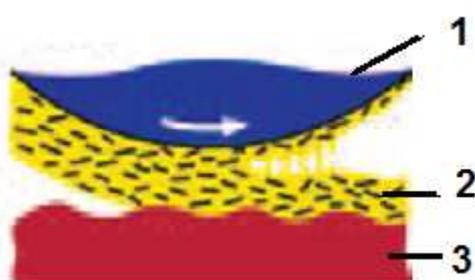
Рис.1 Принцип валкового нанесения поверхностного слоя: 1 – вал; 2 – мембранный слой ПЭК; 3 – подложка
