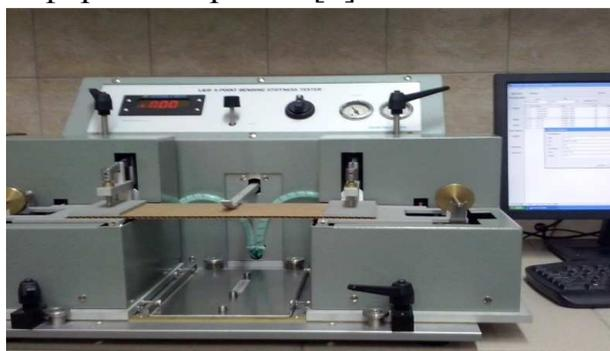
Рис. 1. Внешний вид прибора L&W 4-point Bending Stiffness Tester SE108 для определения жесткости при изгибе по 4-х точечному методу
