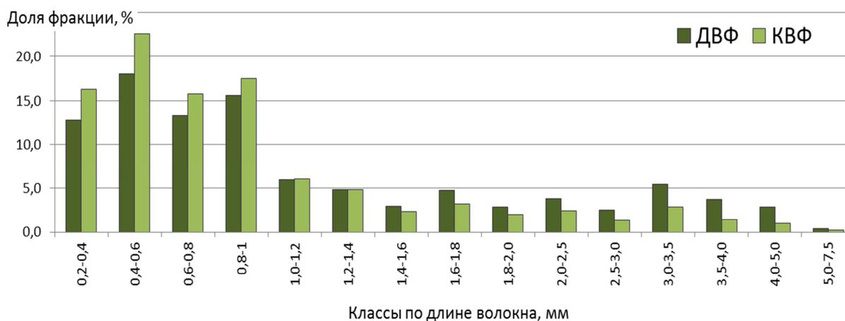
Рис. 1. Сравнение фракционного состава ДВФ и КВФ, полученных на промышленном фракционаторе
