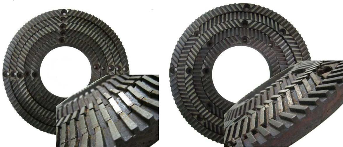
Рис. 1. Ножевая размалывающая гарнитура с пространственным расположением ножей в трех плоскостях  $XYZ$
