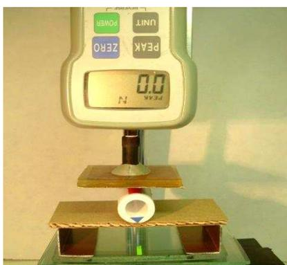
Рис.9. Образец гофрокартона длиной 100 мм (вдоль гофров) и шириной 50 мм устанавливают на двух опорах, в середину образца кладут валик и сверху прилагают усилие
