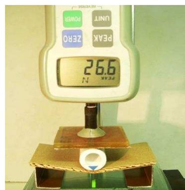
Рис.10. В процессе приложения усилия на изгиб гофрокартон ломается и динамометр фиксирует пиковое значение усилия при разрушении гофрокартона
