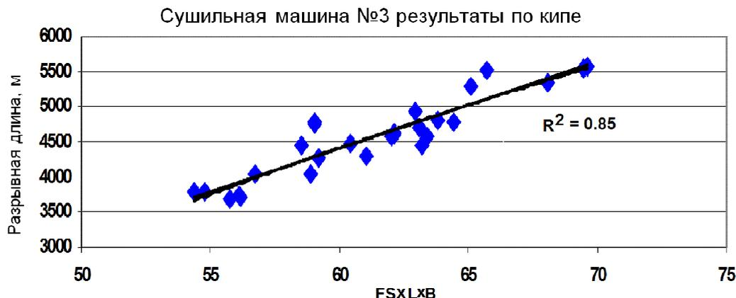
Рис. 4. Корреляция между индексом качества волокна, полученным на системе Пулмак Z-span, и разрывной длиной (данные предприятия в Канаде)
