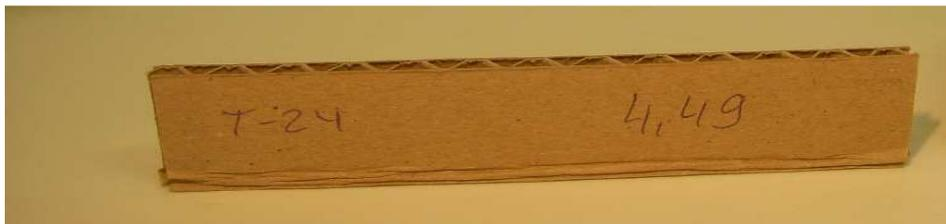
Рис.2. Внешний вид образцов гофрокартона после испытаний на торцевое сжатие вдоль гофров *ECT*
