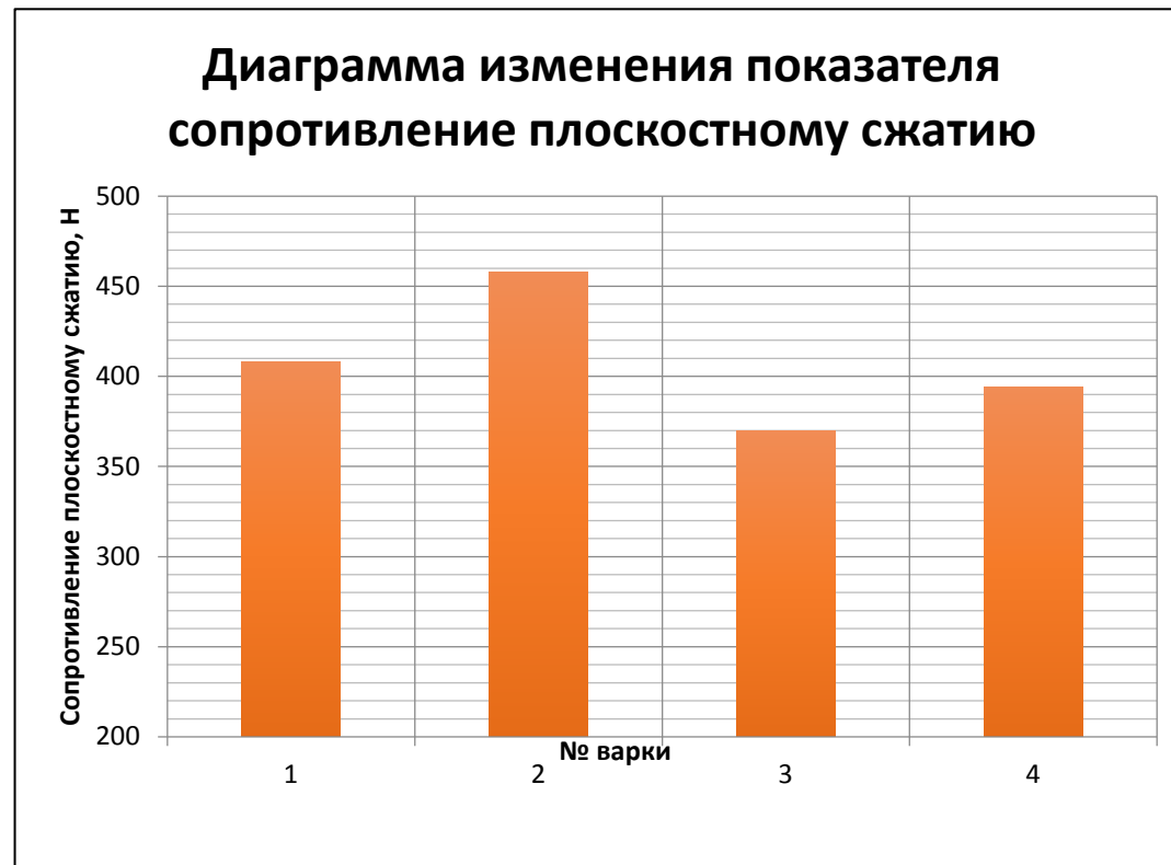
Рис. 2. Диаграмма изменения показателя сопротивления плоскостному сжатию (Н) от варки НСПЦ: 1 – варочный раствор состава \text{Na}_2\text{SO}_3 + (\text{NH}_4)_2\text{SO}_3 + \text{NaOH} ; 2-4 – варочные растворы состава \text{Na}_2\text{SO}_3 + \text{NaOH} с увеличением расхода щелочной добавки.
