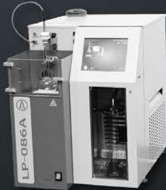
Автоматический аппарат для определения фракционного состава нефти и нефтепродуктов
