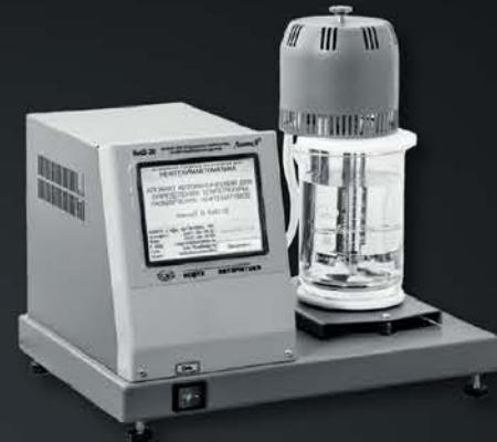
Автоматический аппарат для определения температуры размягчения
