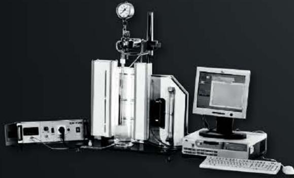
Установка по определению пенообразования
