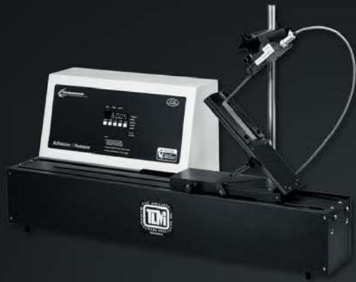
Машина испытания адгезии и усилия отрыва лайкера
