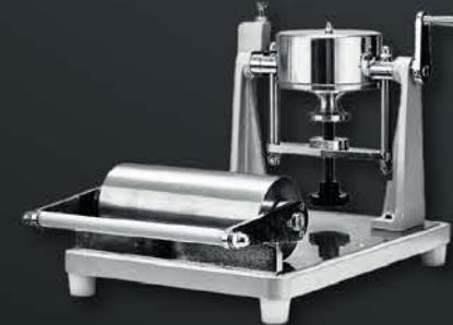
Прибор для определения поверхностной впитываемости бумаги и картона по методу Кобба
