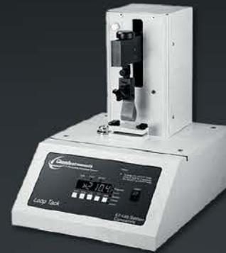
Прибор для измерения липкости методом «петли»
