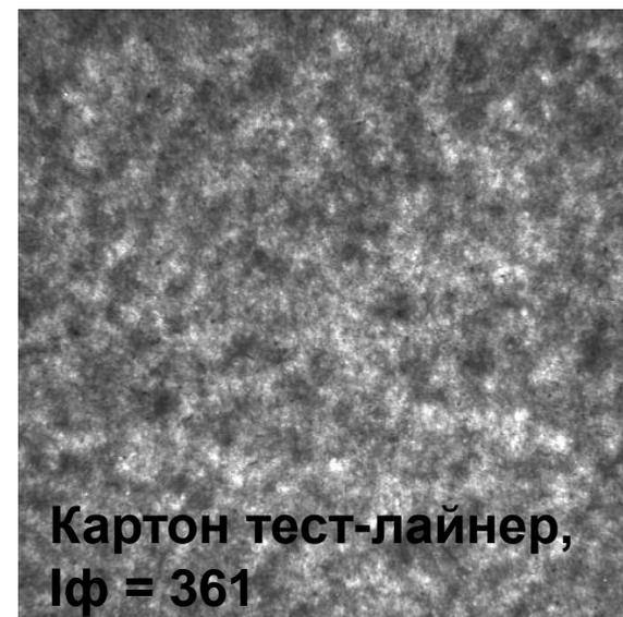
Пример изображения просвета бумаги и картона, полученных в проходящем поляризованном свете на анализаторе формирования PTI Formation Tester, образец 120×120 мм
