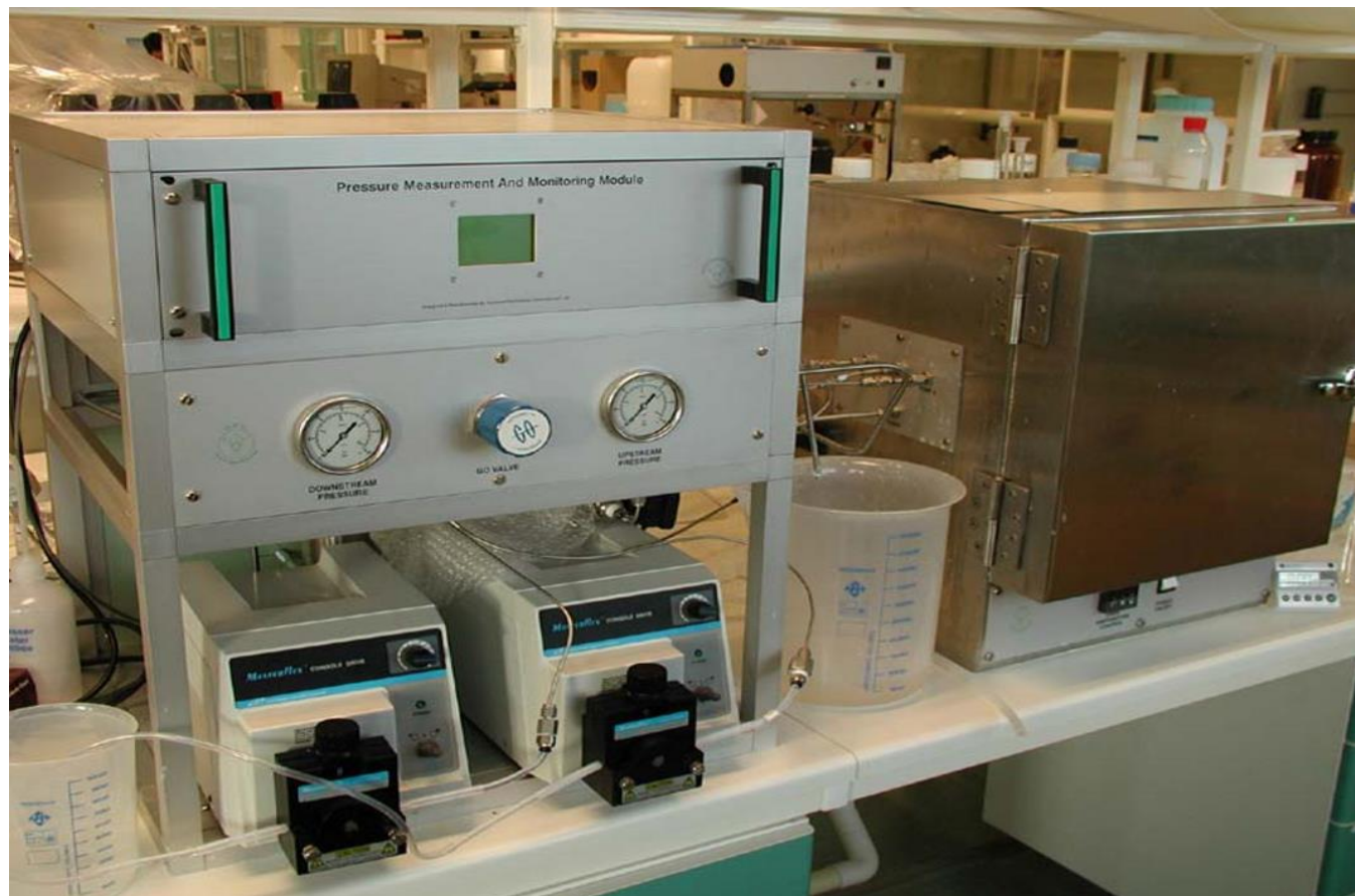
Рисунок 3 – Установка по моделированию накипеобразования.
