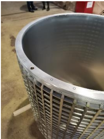
5 «Сито фракционатора _щелевое, обозначение по схеме _»
