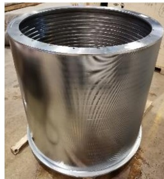
14 «Сито _ первая ступень машинного сортирования, обозначение на схеме _»
