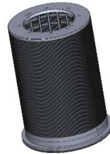
15 «Сито _ вторая ступень машинного сортирования, обозначение на схеме __»
