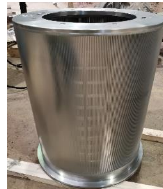
15 «Сито _ вторая ступень машинного сортирования, обозначение на схеме __»
