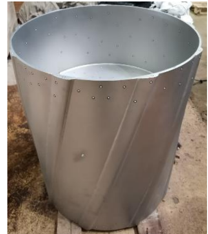
8 «Ротор Леор сортировки _ первая ступень грубого сортирования, обозначение по схеме _»
