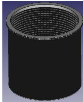
14 «Сито _ первая ступень машинного сортирования, обозначение на схеме _»
