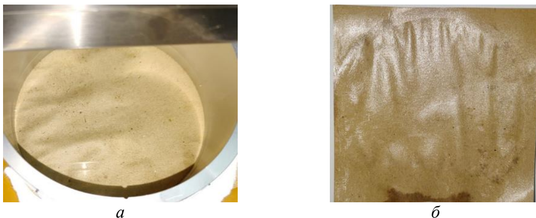
Рис. 3. Испытание на впитываемость по методу Кобб 1800 : а – внешний вид образца во время испытаний; б – внешний вид образца после испытаний
