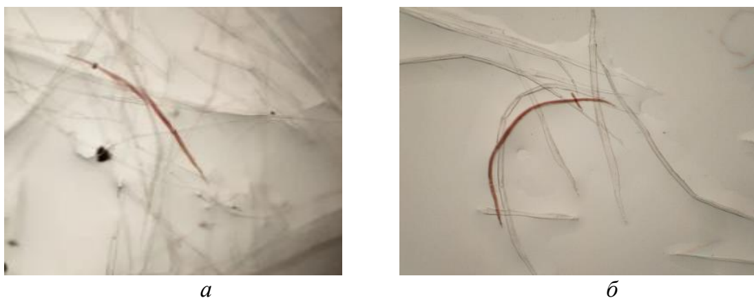
Рис. 2. Микроскопические снимки (при 100 кратном увеличении) волокон сульфатной целлюлозы, полученной при варке с СИНАЛАБ 74418SR и промывки с СИНАЛАБ PP10-3152
