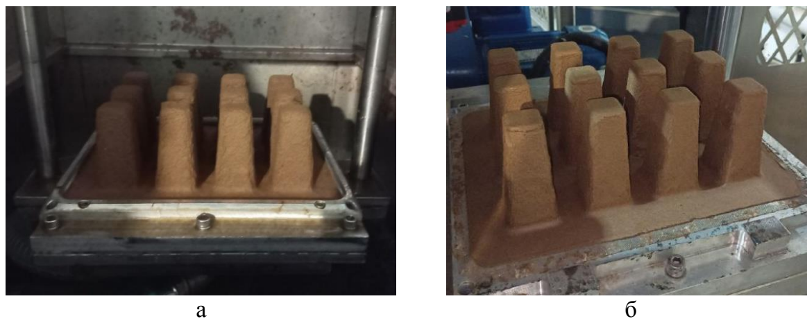
Рис. 1. Биоразлагаемая кассета: а – после формования из суспензии; б – после термоформинга
