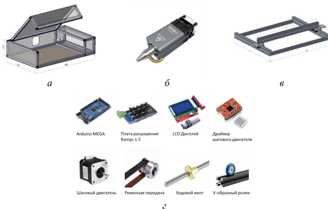
Рис. 4. Устройство: а – защитная кожа, б – лазерная головка, в – алюминиевая рама, г – набор комплектующих
