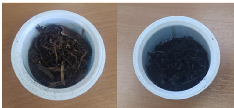
Рис. 2. Внешний вид древесного топлива, торрефицированного при температурах 210 и 300 °С
