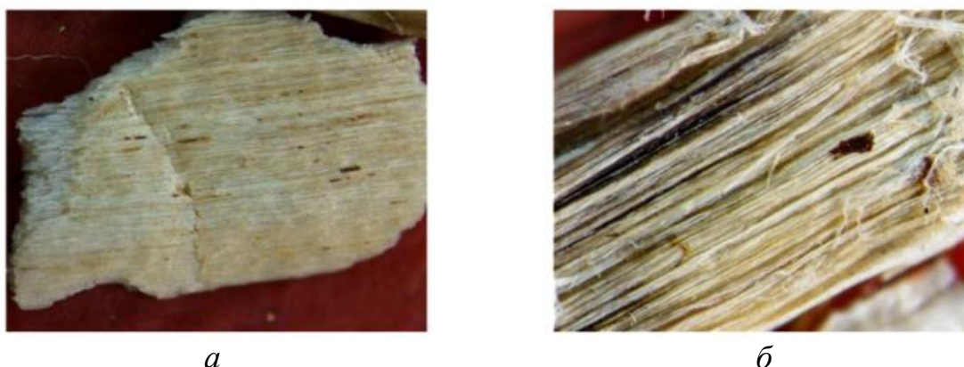
Рис. 1. Микрофотографии образца костры конопли: а – исходного; б – химически модифицированного NaOH, ЭДТА
