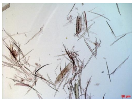
Рис. 1. Микрофотографии конопли технической: a – волокно; б – костра
