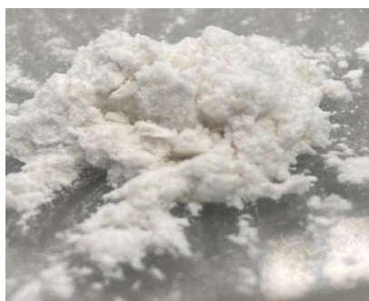
Рис. 5. Микрокристаллическая целлюлоза, полученная из целлюлозы, сваренной из отходов текстильной промышленности
