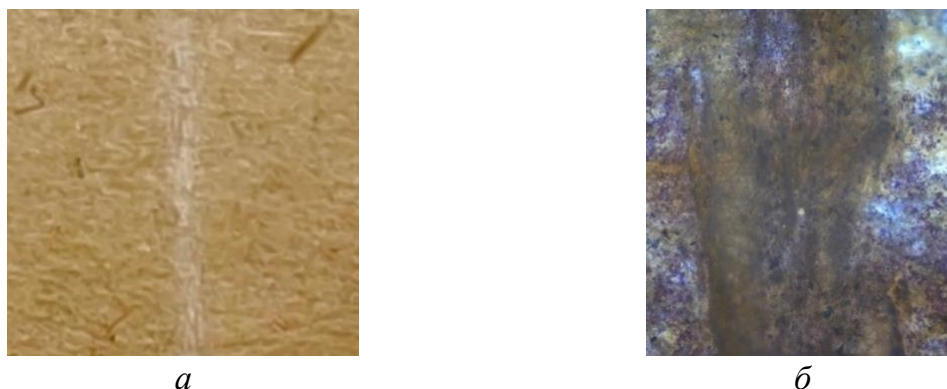
Рис. 5. Механическое повреждение слоя:
