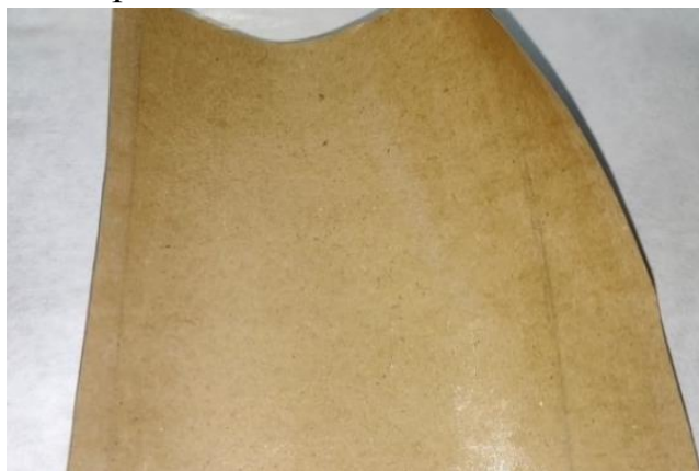
Рис. 2. Картон с нанесенным барьерным покрытием
